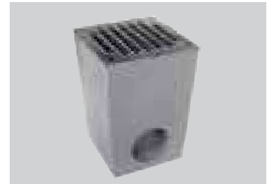
Wpust podwórzowy z polimerbetonu, z rusztem ze stali ocynkowanej, koszem osadczym z PP, odpływem Ø 110 i wymiowanym zasyfonowaniem
